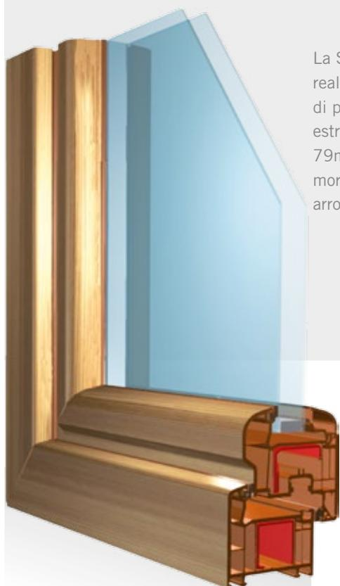
La Serie **V70R** IFORTInfissi è realizzata con profili telaio da 70mm di profondità a 5 camere di isolamento estrusi in "Classe RAL A". L'anta da 79mm colpisce con il fascino morbido del profilo semicomplanare arrotondato e viene rifinita con profili
