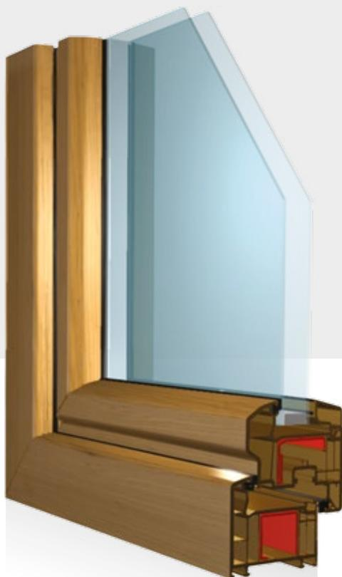
La Serie **V70** IFORTInfissi è realizzata con profili telaio da 70mm di profondità e 5 camere di isolamento. L'anta semicomplanare da 79mm viene rifinita con listelli fermavetro Style (sagomati), Futur (squadri) o Round (arrotondati). L'ampia gamma di profili unita all'elevato numero di tipologie realizzabili con la **V70** fanno di questa serie la più adatta per qualsiasi esigenza di stile e costruzione.
